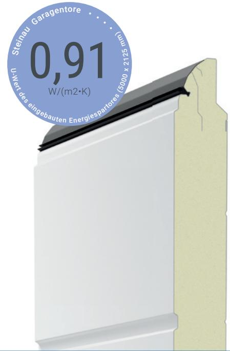
Doppelwandige Tore mit 67 mm starken Lamellen bieten besten Wärmeschutz für Wohnhäuser mit integrierter Garage, z.B. für Passiv- und KfW-Effizienzhäuser.
